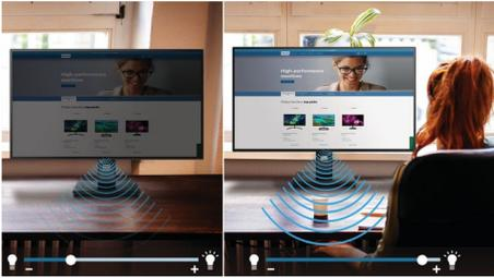
PowerSensor è un sensore integrato che rileva la presenza delle persone. Trasmette e riceve segnali infrarossi non nocivi per determinare l'eventuale presenza di un utente. Se l'utente si allontana dalla scrivania il sensore riduce automaticamente la luminosità dello schermo, riducendo i costi energetici fino al 70% e prolungando la durata di utilizzo dell'apparecchio.
