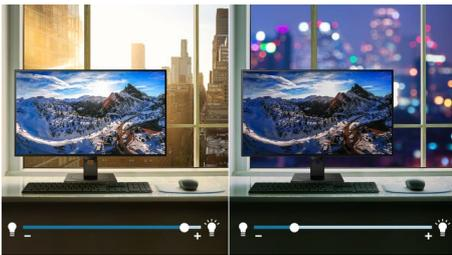
LightSensor utilizza un sensore intelligente per regolare la luminosità dell'immagine a seconda della luce della stanza per un'immagine perfetta con il minimo consumo di energia.
