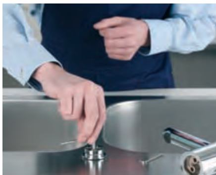
Avvitare, con la prima chiave esagonale in dotazione, il dispositivo di bloccaggio. Con tale operazione la base viene fissata al lavello.
